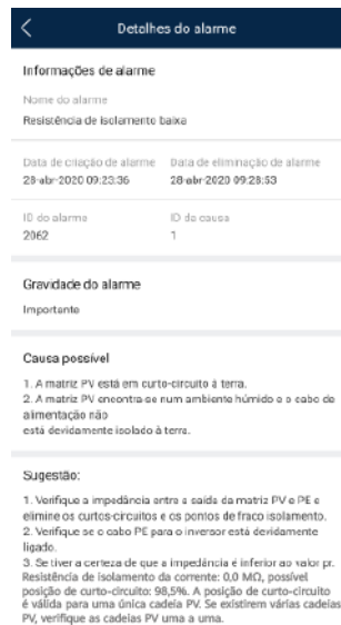
Figura E-1 Detalhes do alarme
